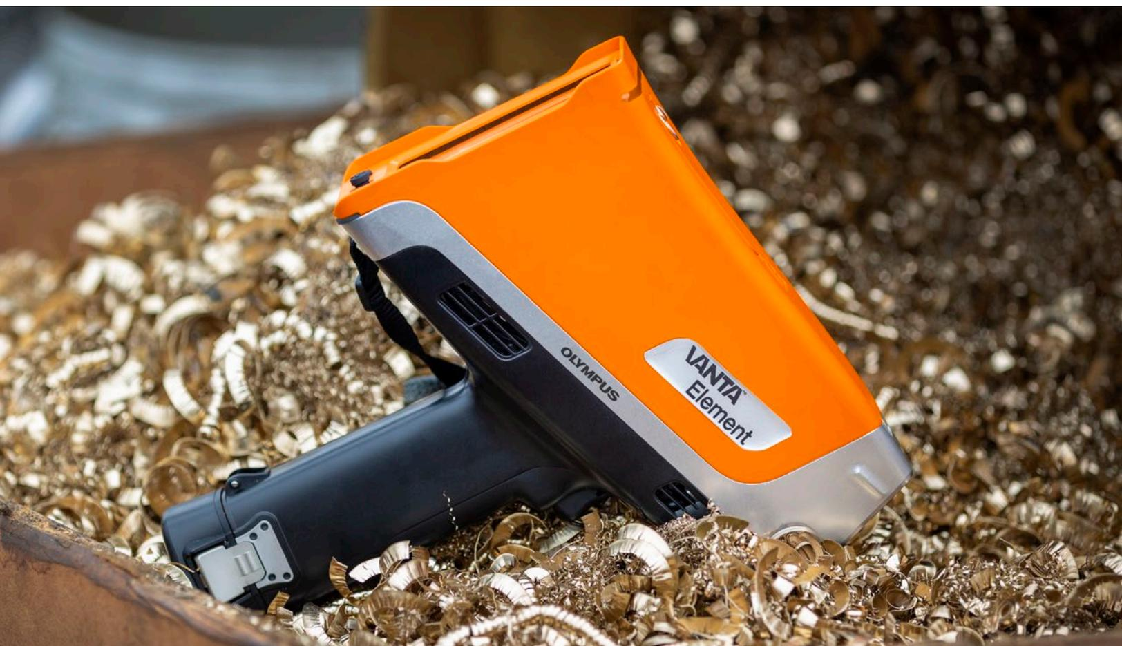
Портативные анализаторы XRF серии Vanta™ имеют прочную конструкцию и предназначены для аналитических задач в самых жестких условиях. Анализаторы Vanta Element имеют степень защиты IP54 для защиты от пыли и воды, проходят испытания на падение и рассчитаны на непрерывную работу в диапазоне температур от -10 °C до 45 °C (от 14 °F до 113 °F).
